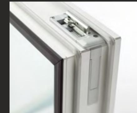
Hier verbirgt sich die neue **I-tec Verriegelung**, die ein Aushebeln des Fensters unmöglich macht – konkurrenzlos in der Branche. Integrierte Kappen drücken beim Verriegeln an allen Seiten in das Rahmeninnere und bieten so maximalen Einbruchschutz.
