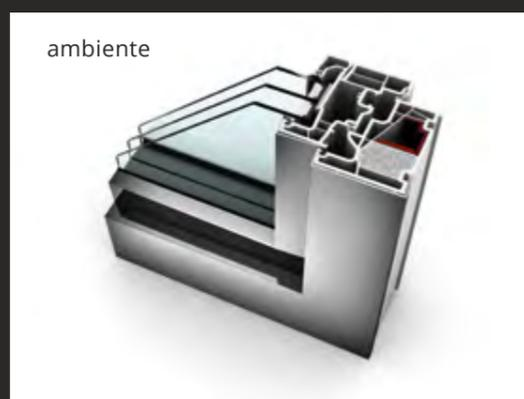
Durch die neue Isolier-Technologie **I-tec Insulation** ist der Rahmen lückenlos gedämmt und die Wärmedämmung deutlich verbessert. Hierbei wird ein Granulat mit Druck in das Rahmeninnere der Kunststoff/ Aluminium-Fenster eingebracht und die Hohlkammern umlaufend gleichmäßig befüllt.
